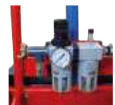
Filtre régulateur lubrificateur avec prise d'air sec pour gonflage des pneus
