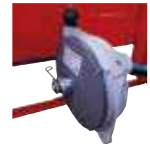
Équilibreur de charge pour le maintien de la clé à chocs
